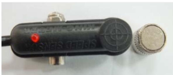
Fixe o sensor de velocidade na balança do lado esquerdo.
