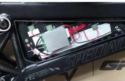
Os componentes de bateria são inseridos e organizados no caso
