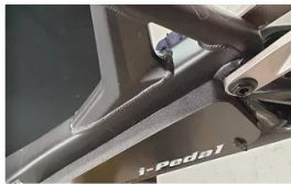
O resultado final é a bateria perfeitamente encaixada no quadro
