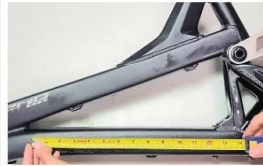
A bateria sob medida é projetada a partir de uma foto do perfil do quadro
