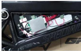
Os componentes da bateria são inseridos e organizados no caso
